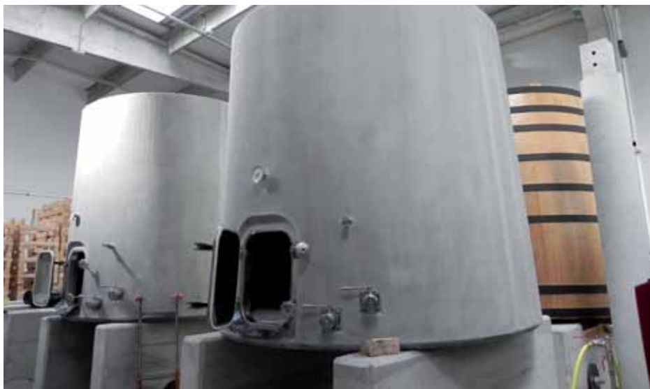
U procesu proizvodnje, uz barrique, rabe se i veće drvene bačve konusna oblika te posude od cementa nove i francuske produkcije a također konusna oblika te zapremnine 60 hl.
