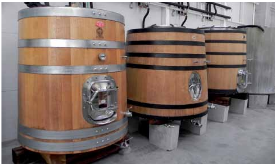
U procesu proizvodnje, uz barrique, rabe se i veće drvene bačve konusna oblika te posude od cementa nove i francuske produkcije a također konusna oblika te zapremnine 60 hl.
